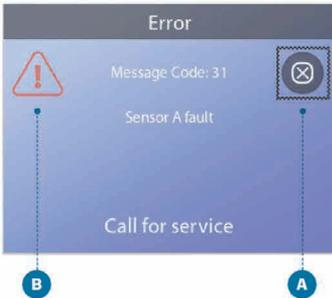
Standardmäßig wechselt in der Grundeinstellung das Auswahlfeld zu den Symbolen *Clear* (Löschen) oder *Exit* (Beenden) auf dem Bildschirm Anzeigen **A** Drücken Sie die LINKE Navigationstaste, um das Auswahlfeld auf das Symbol *Error/Warning/Reminder* (Fehler/Warnung/Erinnerung) **B** zu verschieben, und drücken Sie dann die Navigationstaste SELECT (AUSWÄHLEN), um zum Bildschirm Systeminformationen zu gelangen (siehe Kapitel 5.11).
